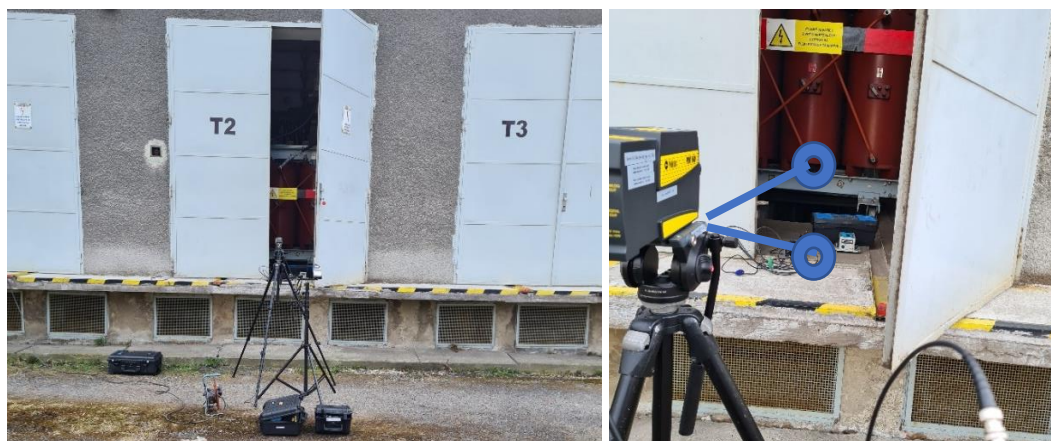
Obr. 5.1.2 FFT analýza bezkontaktné snímanej efektívnej v_{ef} hodnoty rýchlosti vibrácií Polytec PDV 100 na fráme olejového transformátora T2 v smere „x“.
